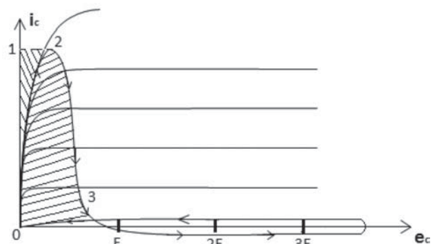
Рис. 3. ДХ ГВВ в режиме класса Е (гладкий режим)
