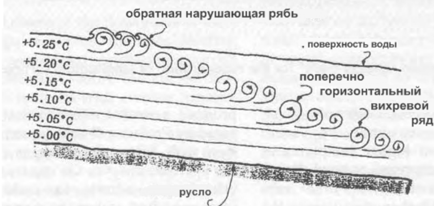
Fig. 13.8 Продольные турбулентные вихри
