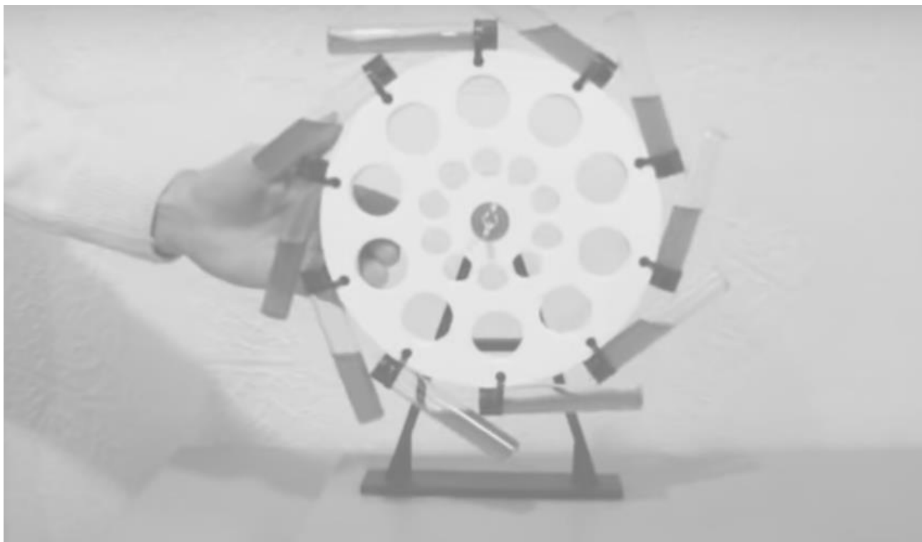
Рис.1. Гравитационно механический двигатель с колбами (Bhāskara Wheel), создающими неравенство моментов действия гравитационной силы на валу двигателя
