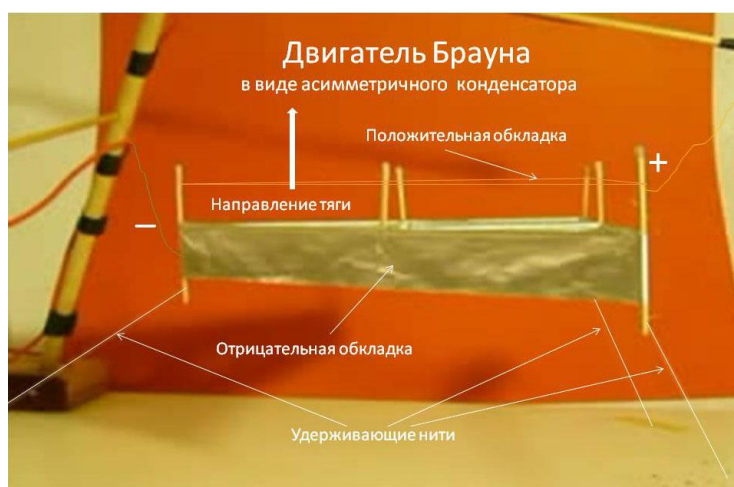
Рис.12. Двигатель Брауна в виде асимметричного конденсатора
