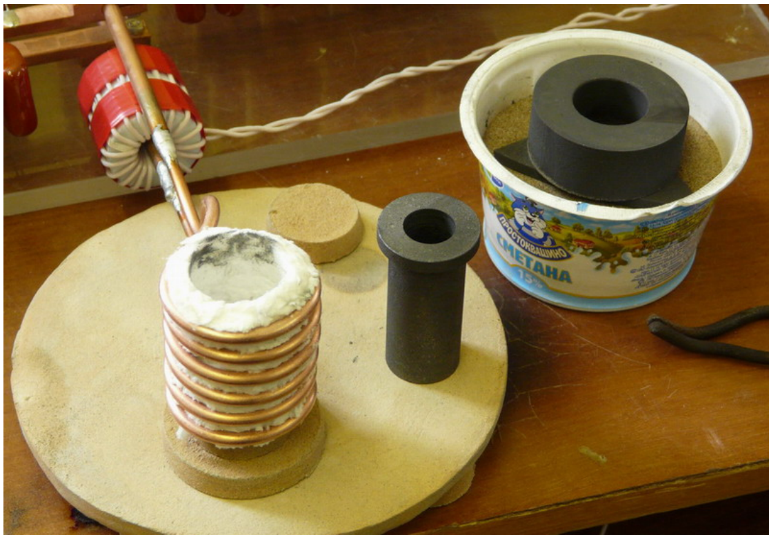
Рис.14. Подготовка к тигельной плавке.
