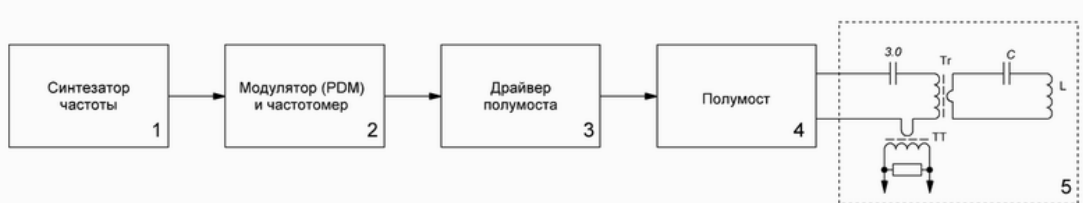
Рис.1. Блок-схема инвертора.
