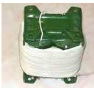
Обычный сердечник из пластин трансформаторной стали, предназначенный для 50-60 Гц (размер не имеет значения). Общая индуктивность  $L_S$  около 100 мГн (не важно).
