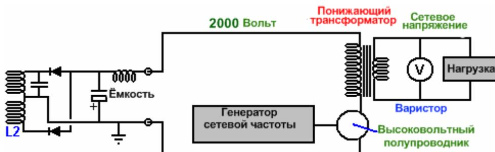
**Комментарий:** нет никакого высокочастотного высоковольтного понижающего трансформатора, а используется понижающий трансформатор для частоты сети, что означает, что потребуются огромный сердечник.
