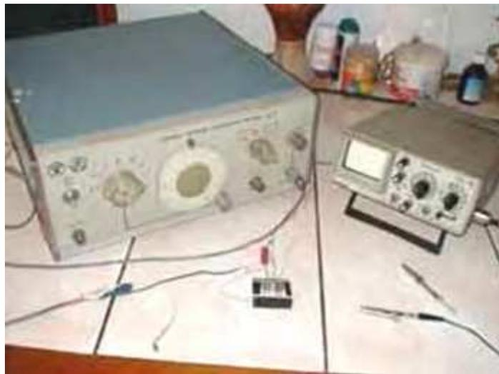
В этом случае была использована специальная установка, состоящая из аналогового осциллографа, цифрового вольтметра и генератора сигналов.
