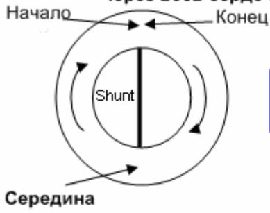
**Второй слой** - Входная и выходная катушки
