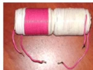
**Комментарий:** позиции катушек на стержне зависят от ферромагнитного материала, который используется, и от его размера.
