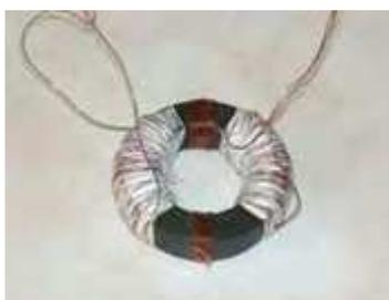
Катушка была намотана на тороидальном ферромагнитном сердечнике с проницаемостью 1000 (не важно). Каждая половина катушки составляла 200 витков (не важно), из проволоки диаметром 0,33 мм (не важно). Общая  $L_S$  индуктивность составляет около 4 мГн (не важно).
