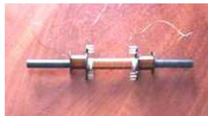
**Пояснение:** центральная часть катушки, и её две крайние секции на концах, наматываются в противоположных направлениях.
