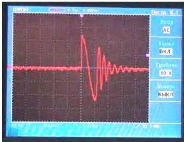
**Результат:** точность перезаряда конденсатора улучшилась до 5 процентов (из-за устранения влияния первого диода). На основе частоты колебаний, которая была от 4 до 5 раз выше, чем у основного конденсатора, можно было оценить распределённую емкость - от 16 до 25 раз ниже, чем у основного конденсатора.
