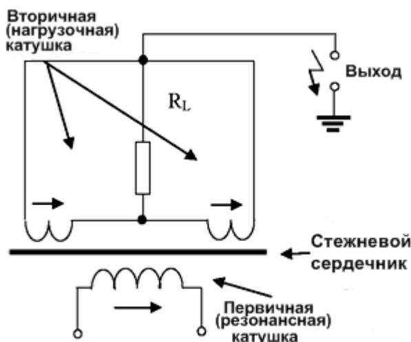
**Пояснение:** электромагнитные поля, создаваемые резонансным (возбуждающим) током и током нагрузки перпендикулярны друг другу:
