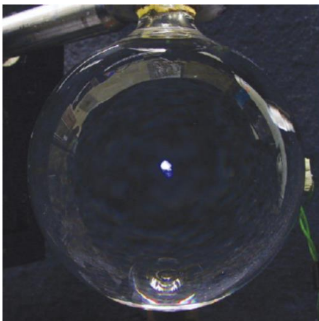
Рис. 1. Периодическая однопузырьковая сонолюминесценция: свечение газового пузырька в центре стеклянной колбы с жидкостью (Flannigan D.J., Suslick K.S. // Nature Physics . 2010. V. 6. P. 598-601).
